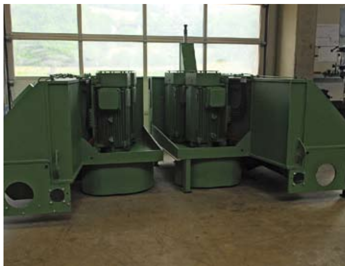
Ein im Rohbau befindliches Profilieraggregat für eine SAB-Spanerlinie, die in Russland installiert wird
