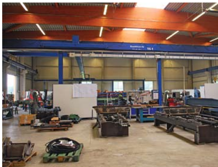
Ein 16-t- sowie ein 5-t-Kran sorgen in der neuen Produktionshalle für ein problemloses Handling der schweren Maschinenteile
