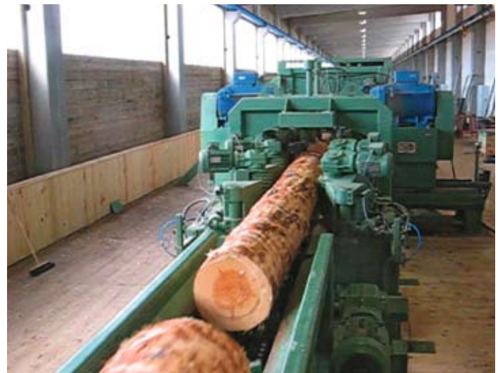
Blick in die Anlage bei HMS-Holz in Hagenow: Einzugsförderer mit automatischer Stammeindrehung vor Parallelspaner PSP 700
