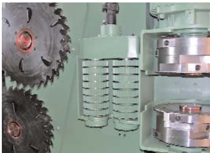
Profilieraggregat mit Säge- und Profilerstativen, die über Linearführungen verstellbar sind
