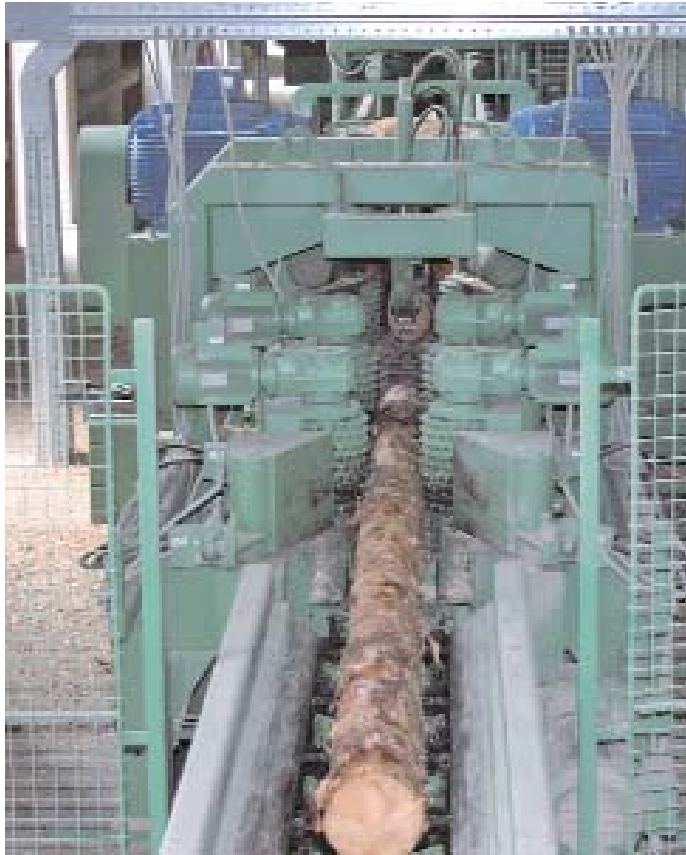
Spaneraggregat – Vorschubgeschwindigkeit bis zu 120 m/min
