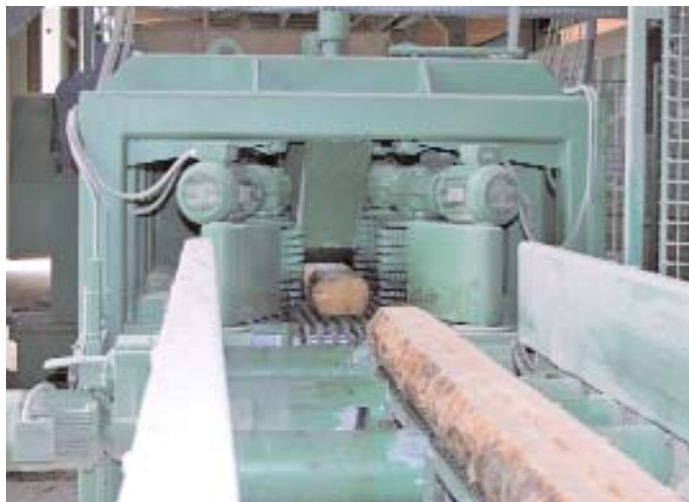
Einzugsaggregat vor dem zweiten Spaner sorgt für die optimale Ausrichtung der Model
