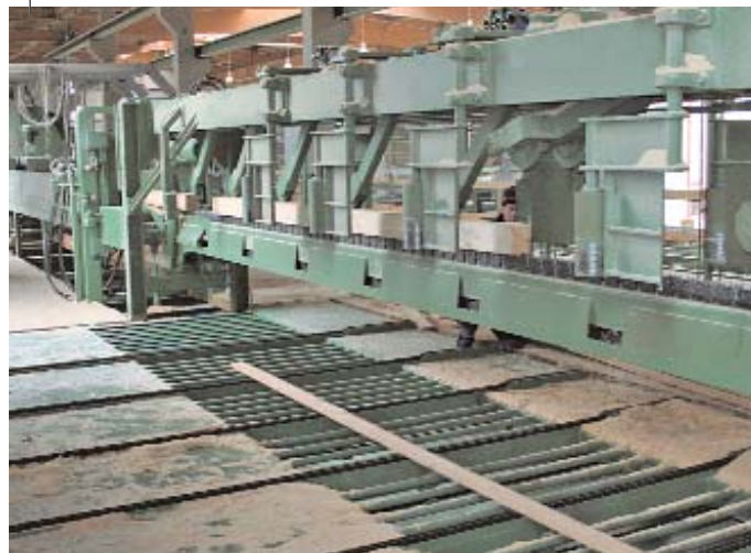
Seitenware wird abtransportiert, Hauptware geht weiter zur Kreuzschnittanlage
