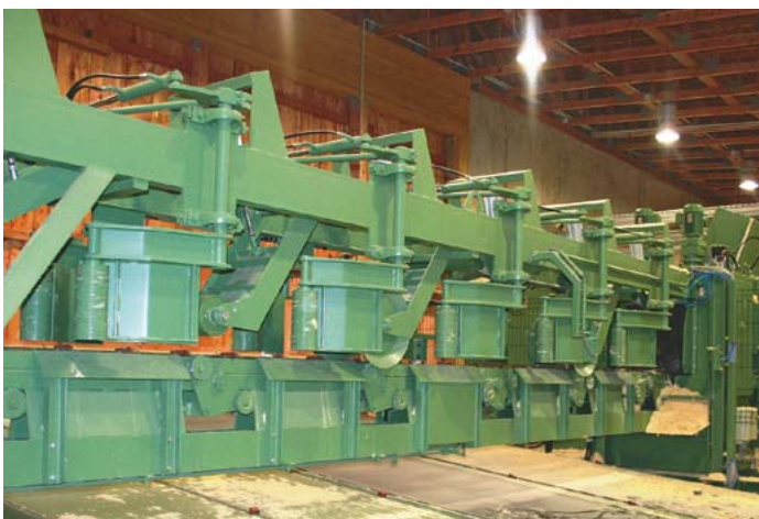
Brettabscheider hinter dem Doppelwellen-Universal-Kreissägenaggregat trennt Seiten- von der Hauptware
