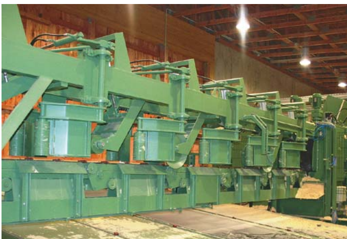
Brettabscheider hinter dem Doppelwellen-Universal-Kreissägenaggregat trennt Seiten- von der Hauptware
