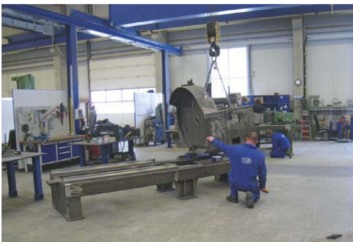
Parallelspaner Typ PSP 700 bei Montagebinn in der SAB-Werkstatt in Bad Berleburg
