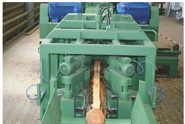
Nachschnitteinzug bei HMS mit automatischer Modelausrichtung vor dem zweiten Spaner
